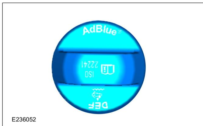
Il bocchettone di riempimento del serbatoio del liquido di scarico diesel (AdBlue®) si trova accanto al bocchettone di riempimento del carburante e ha un tappo blu. Riempire il serbatoio utilizzando l'apposita pompa presso una stazione di rifornimento per liquido di scarico diesel (AdBlue®) oppure con una tanica contenente il liquido AdBlue®. La capacità del serbatoio di AdBlue® è di 20 litri.
